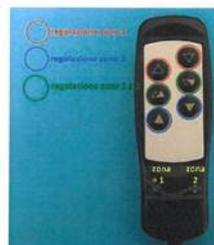
Il semplice rilascio del pulsante del telecomando provoca il blocco del movimento del motore.
